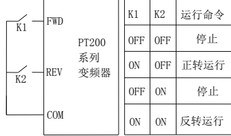
图 6-10 两线式控制（使能与方向分离）
