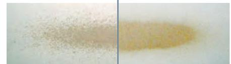
粗い霧で飛散しないソフトなスプレー      細かくて仕上がりがきれいなスプレー
