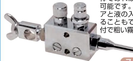
丸吹き、内部混合噴霧。液体の吸引力が強いので、低粘度の液体であれば吸い上げ式で噴霧も可能です。複数個を連結し、エアと液の入口を一箇所で使用することもできます。エア調節器付で粗い霧にもできます。
