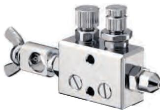
細丸吹き、外部混合噴霧。ノズル口径φ0.6で少量の液体を噴霧するのに最適です。複数個を連結し、エアと液の入口を一箇所で使用することもできます。エア調節器付で粗い霧にもできます。
