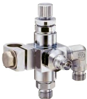
小さい丸吹きです。エア消費量が少なく微細なスプレーができ、印刷マーキング・加湿などに適します。製品かスプレーガンを移動させれば線引きができます。分離型のHM-6Pもあります。※スプレーパタンφ2~φ40（吹付距離、エア圧、液量の調節による）
