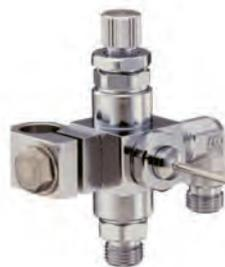
針ノズル丸吹の標準型。細いパイプの内面、入り組んだスキ間の奥側等へ潤滑剤、コーティング液などを塗布する時に最適です。針ノズルはご希望の長さ、太さ、角度の特注品もお受けできます。(P.12参照)
