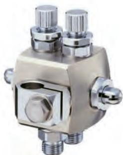
左右両吹き型の平吹。液量調節器が2個付で液量は左右別々に調節できます。本体アルミ製で無電解ニッケルメッキ付。腐食性の液体（酸、アルカリ）は使用できません。
